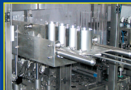
specjalny, buforowy zasobnik wieczek, wysuwany poza strefę roboczą dla wyższej higieny i łatwości obsługi special lids buffer magazine pulled out of the working zone for easy operation and improved hygiene
