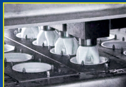
sekcja dozowania produktów płynnych liquid products dosing section
