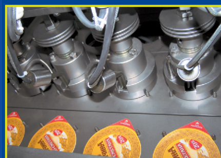
stacja zgrzewania wstępnie wyciętych wieczek sealing station for pre-cut lids
